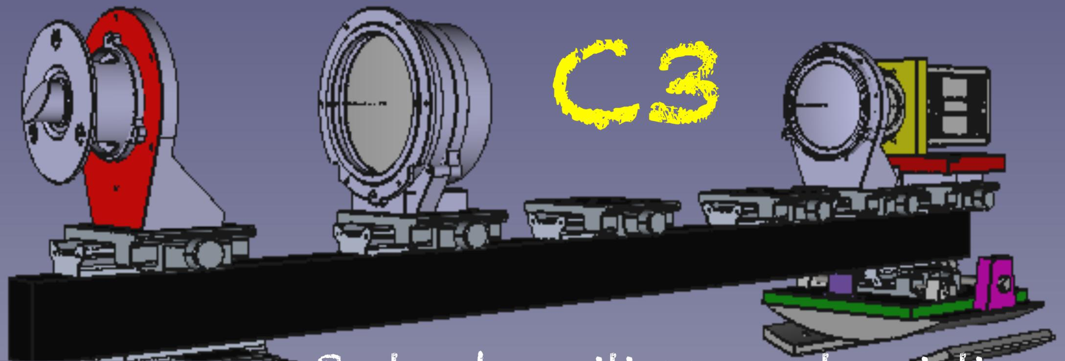
Poutre de positionnement, maintien et réglages des sous ensembles optiques en Invar, reçue et envoyée à l'usinage.
